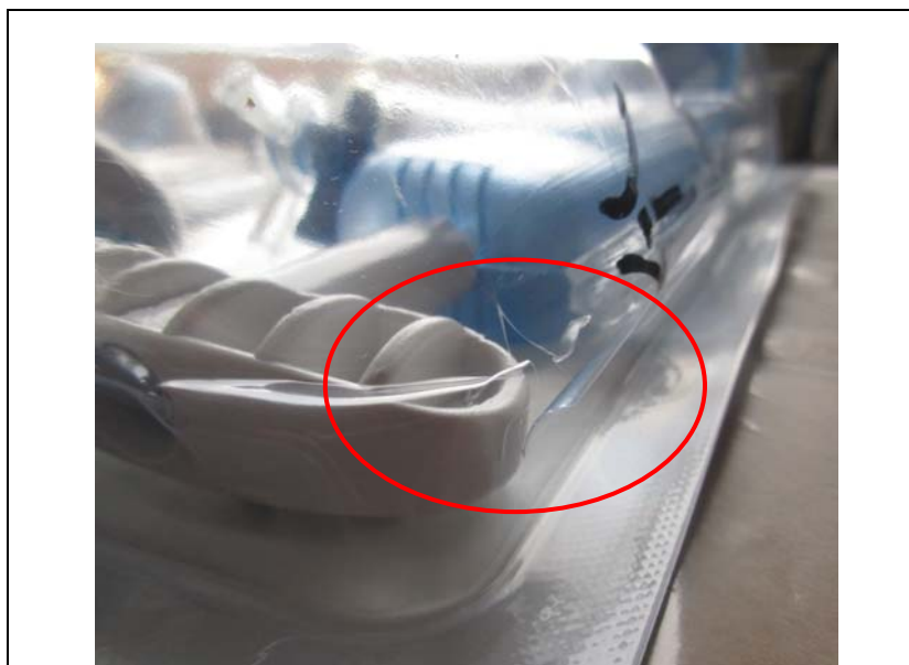
Image 1 : Exemple de fissure observée à proximité de la poignée du système d'inflation DOLPHIN
