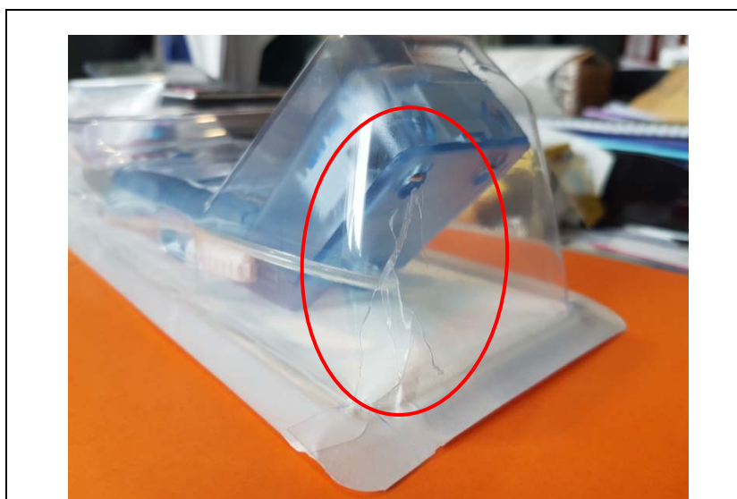
Image 2 : Exemple de fissure observée à proximité du manomètre du système d'inflation DOLPHIN
