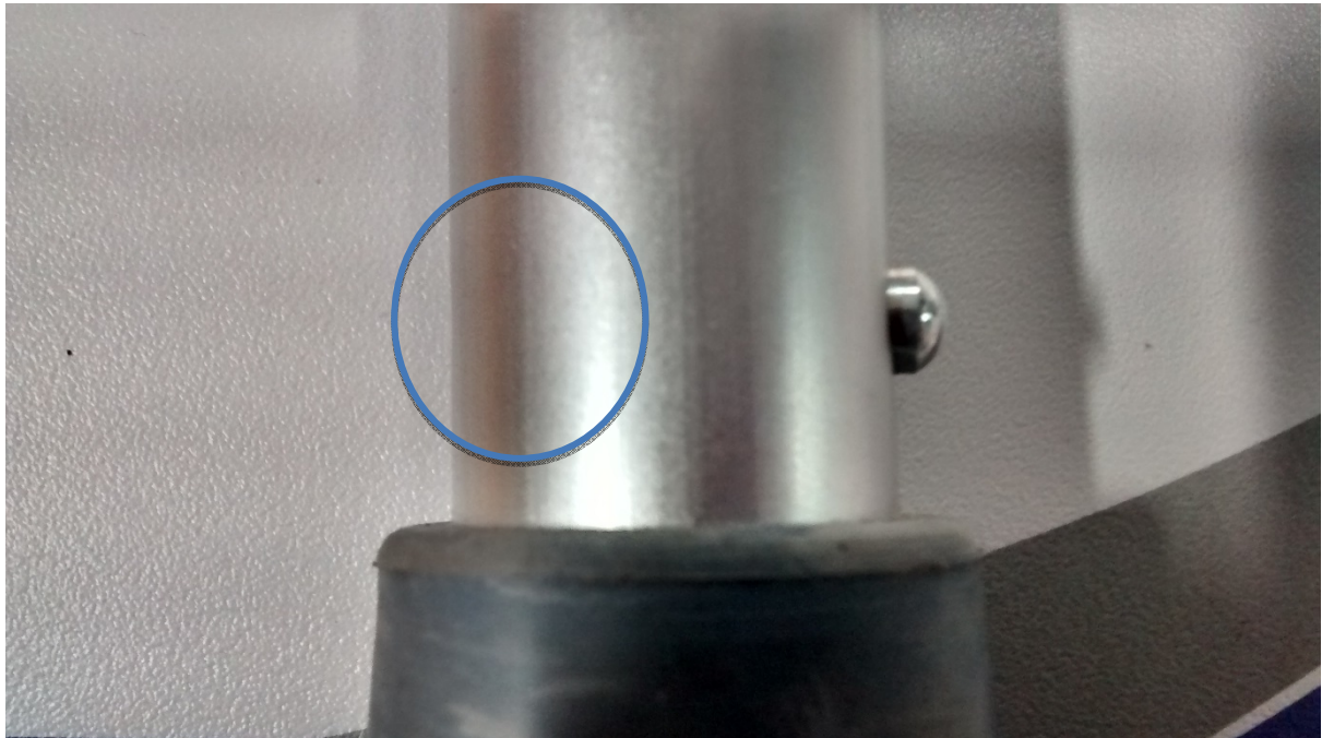
Image 2 : il manque une goupille de boutons à ressort
