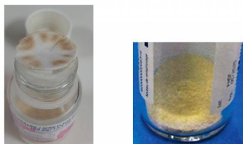
Opercule mal scellé / poudre jaunâtre
