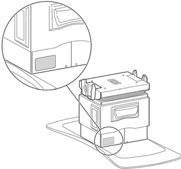
**Fig. 1** Position de la plaque signalétique/étiquette
