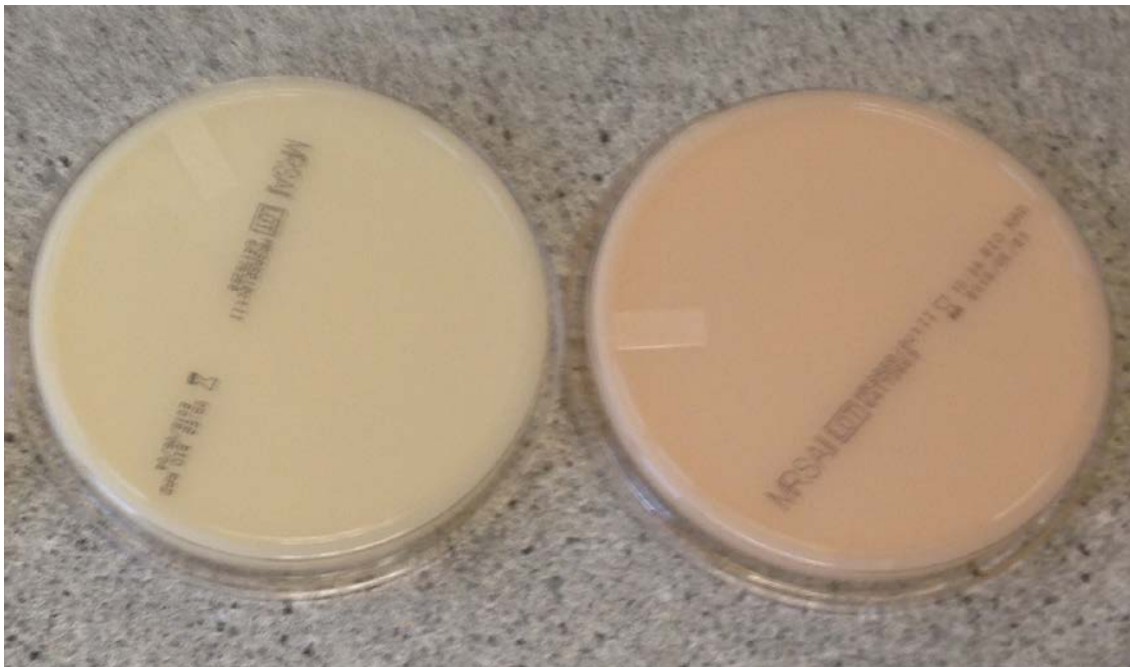
A gauche : couleur conforme A droite : couleur non-conforme, nuance orangée
