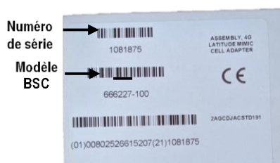
Figure 2. Étiquetage de l'emballage de l'adaptateur cellulaire 4G MIMIC LATITUDE, le modèle Boston Scientific (BSC) étant le 6227.
