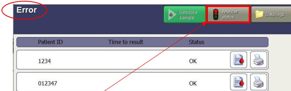
Appuyer sur **Etat Analyseur** pour afficher la condition qui a amené l'analyseur à entrer dans l'état d'erreur (temps de réinitialisation) et le message correspondant (3264) :
