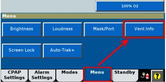
FIGURE 2 : VÉRIFICATION DU NUMÉRO DE SÉRIE DU VENTILATEUR À PARTIR DE L'ÉCRAN
