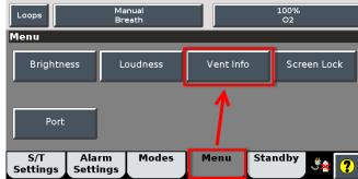
FIGURE 2 : VÉRIFICATION DU NUMÉRO DE SÉRIE DU VENTILATEUR LORSQUE L'APPAREIL EST EN COURS D'UTILISATION
