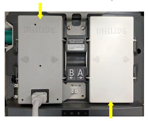
La batterie lithium-ion est insérer dans le compartiment A
