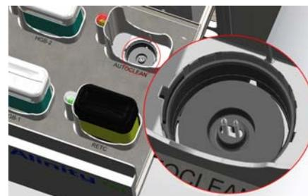
*Schémas du porte-flacon d'Alinity hq Autoclean Solution montrant le dispositif de verrouillage de sécurité couvrant les aiguilles de perçage et le dispositif de verrouillage de sécurité ne couvrant pas les aiguilles de perçage. Les aiguilles de perçage sont identiques sur tous les porte-flacons.*
