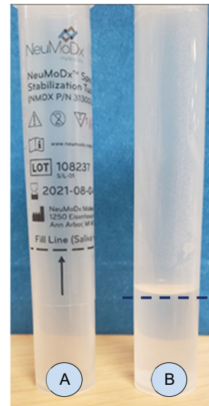
Figure 1. (A) Tube de stabilisation des échantillons avec ligne de remplissage incorrecte. (B) Niveau de liquide représentant la ligne de remplissage correcte.
