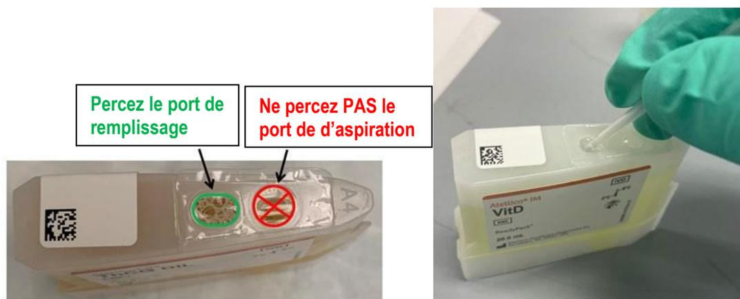
4. Placez un film de remplacement 11208742 sur l'orifice percé comme indiqué dans l'image suivante.
