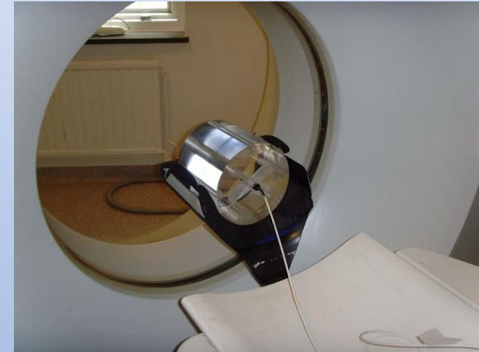
Chambre d'Ionisation Crayon Longueur 10 cm (5.3 cc) ou 30 cm (16.0 cc)
