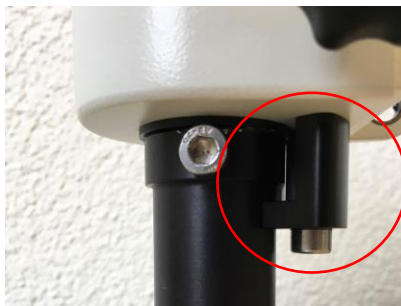
Figure 3 : Vue détaillée du dispositif de fixation de maintien à titre de méthode supplémentaire de blocage du corps de microscope M220
