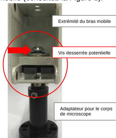
Figure 2 : Vis desserrée potentielle connectant le bras mobile au corps de microscope
