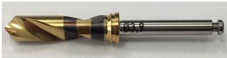
Plusieurs niveaux d'inspection du lot potentiellement concerné n'ayant révélé aucune anomalie, nous supposons qu'il s'agit d'une erreur unique. À ce stade de nos investigations, une confusion entre un foret de  $\varnothing$  4,6 mm isolé et un foret de  $\varnothing$  3,9 mm au cours du processus de fabrication semble être une cause plausible.
