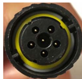
Figure 2. Vue de face des connecteurs de la source d'alimentation électrique
