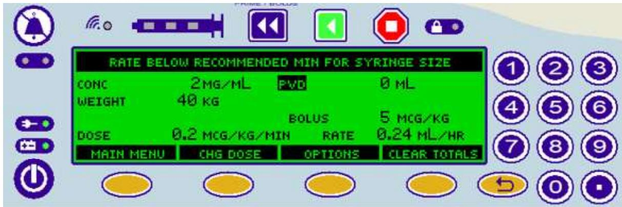
Figure 3 : Fausse alarme de débit inférieur au minimum recommandé pour la taille de la seringue
