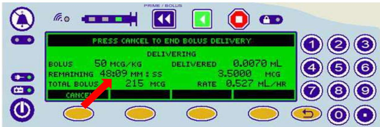
Figure 4 : Exemple de temps restant erroné. « REMAINING 48:09 MM:SS » (Temps restant 48:09 MM:SS) devrait afficher « REMAINING 04:09 MM:SS » (Temps restant 04:09 MM:SS).
