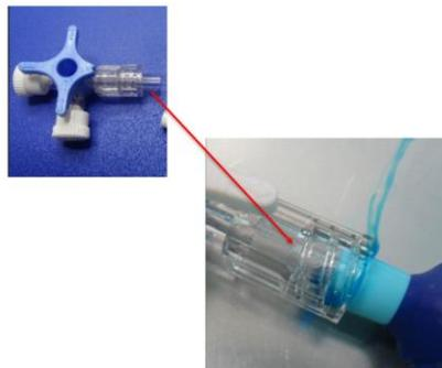
**Figure 1 : Emplacement potentiel de la fuite au niveau du composant du boîtier du robinet**
