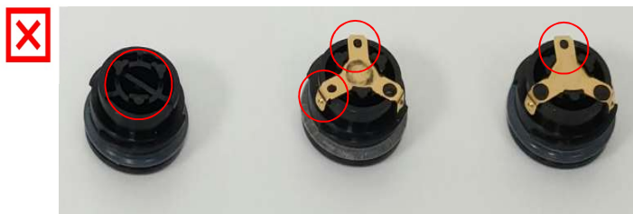
Capuchons de piles endommagés – A ne pas utiliser Contact métallique manquant, un ou plus des 3 points en relief manquant
