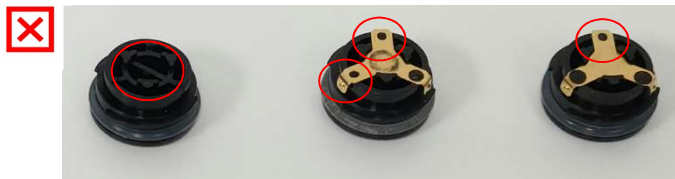
Capuchons de piles endommagés – A ne pas utiliser Contact métallique manquant, un ou plus des 3 points en relief manquant
