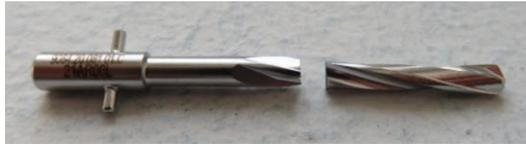
Figure 1. Photo d'un foret hélicoïdal cassé appartenant au lot n°21AR00L transmise par un utilisateur
