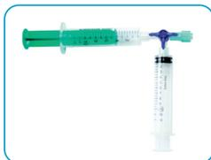
Pour cette méthode, il est recommandé d'utiliser un robinet Luer-lock. Il doit être positionné en oblique lors de la phase d'homogénéisation.
