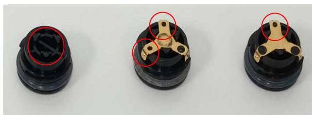
Capuchons de piles endommagés – A ne pas utiliser Contact métallique manquant, un ou plus des 3 points en relief manquant
