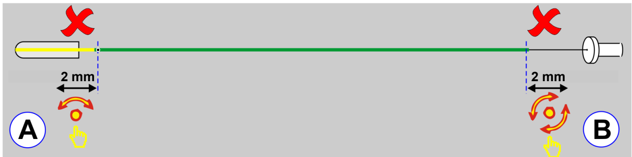
Figure 3. Scénarios A et B dans lesquels l'utilisation de la fonctionnalité Catheter Bending (Courbure cathéter) peut entraîner l'introduction d'une erreur de reconstruction.
