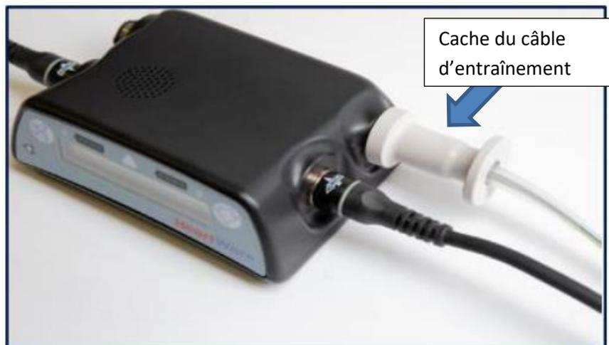
**Figure 1 : Contrôleur avec le cache du câble d'entraînement installé sur le raccordement du câble d'entraînement**
