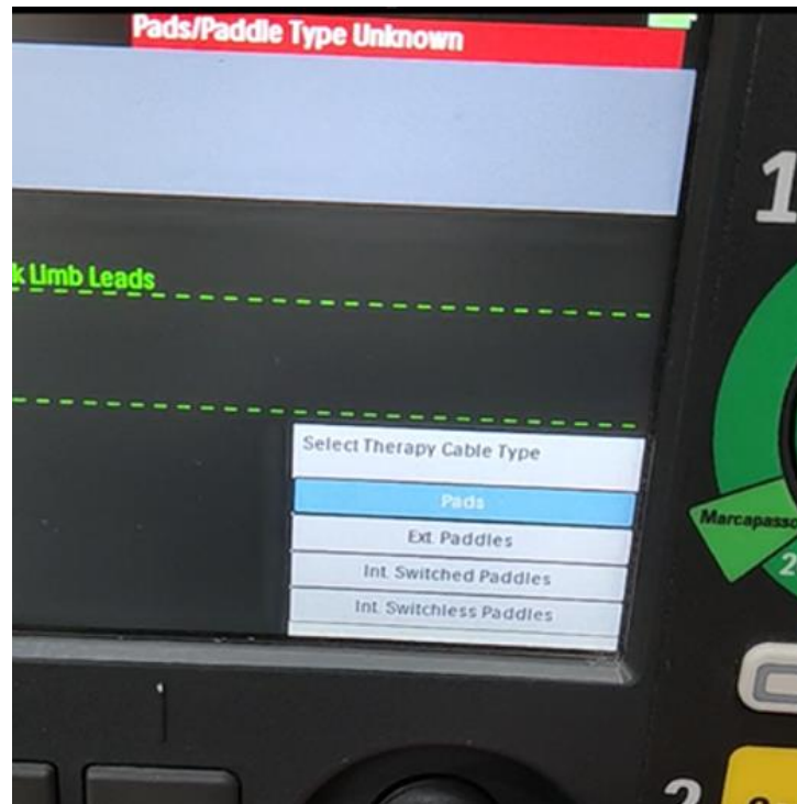
Figure 1 : écran du DFM100 présentant un problème d'identification des palettes.
