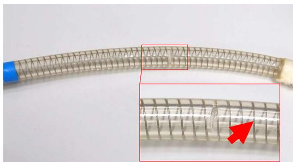
Figure 2 – Exemples de perforation/déchirure
