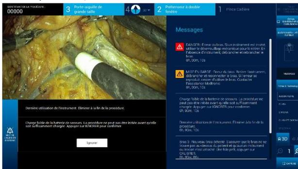
3. Si l'une des erreurs suivantes apparaît dans la liste des messages, redémarrez le bras conformément aux instructions de l'étape 1. Si l'erreur réapparaît, arrêtez le bras en débranchant le câble de données du chariot du bras et mettez le bras hors service.
