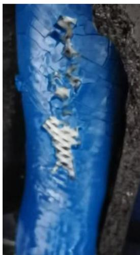
Figure 1 : Tuyau de vidange dégradé
