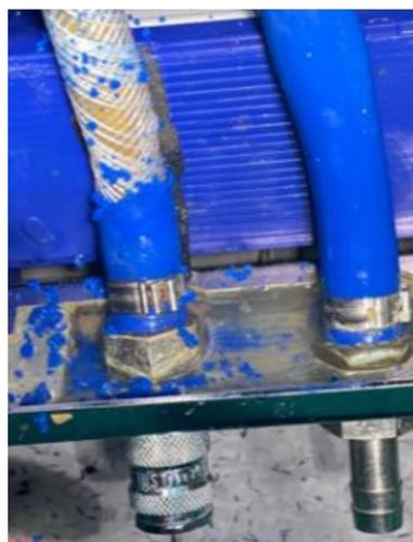
Figure 2 : Tuyau bleu dégradé vs. tuyau bleu intact
