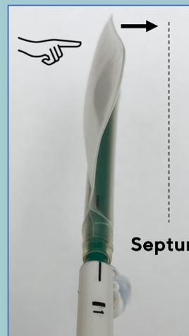
Avec le doigt, préformer le ballonnet de manière à former une vague du côté du septum
