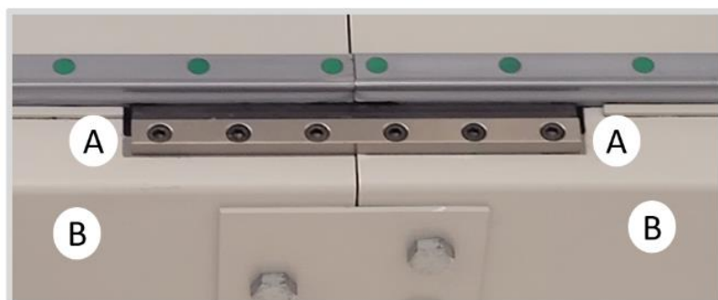
Figure 6. Emplacements où des fissures peuvent se produire
