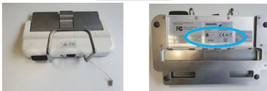
Figure 1 : Emplacement de l'étiquette sous la pédale de commande
