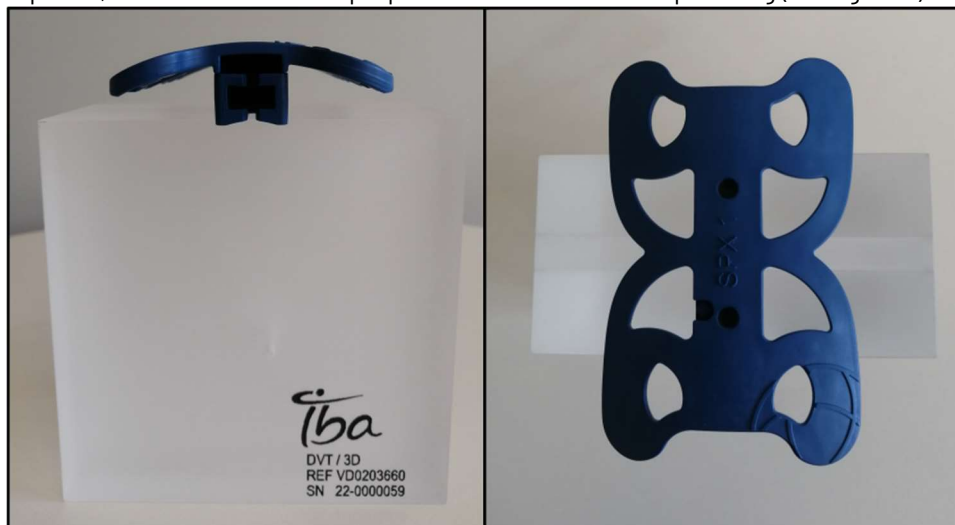
Figure 7 - Placement de l'assemblage SPX1 Phantom - SPX1 Patient Reference sur le fantôme qualité
