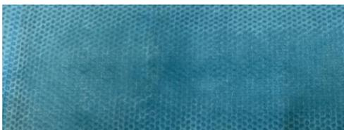
**B. Produit non-conforme après friction humide**
