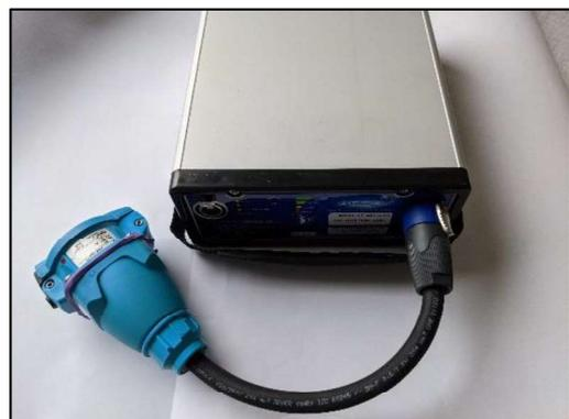
**Figure 7 : Batterie NiMH avec le câble adaptateur NITE**
