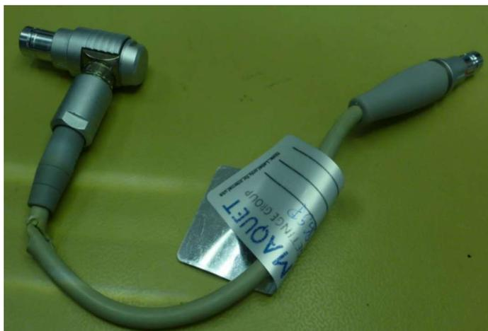
Figure 2 : Exemple d'isolation de câble déchirée sur le terrain
