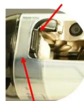
Aucune fissure ou déformation n'est visible sur le capuchon distal
