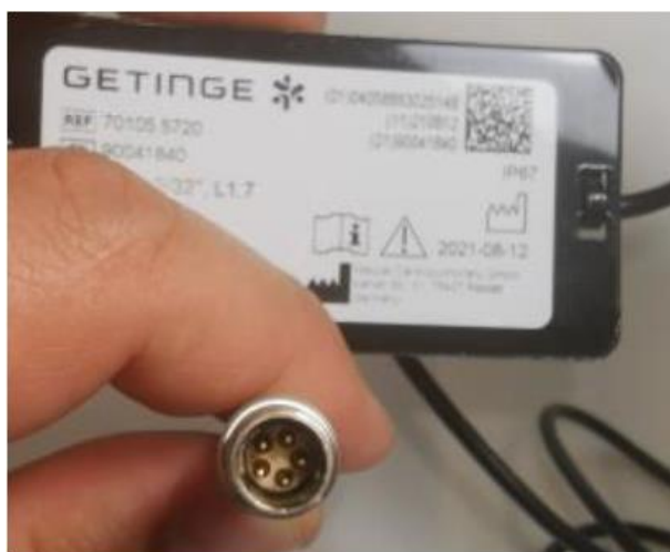
Figure 4 : Connecteur du capteur de bulles CARDIOHELP-i/RotaFlow II (réf. 701055720)
