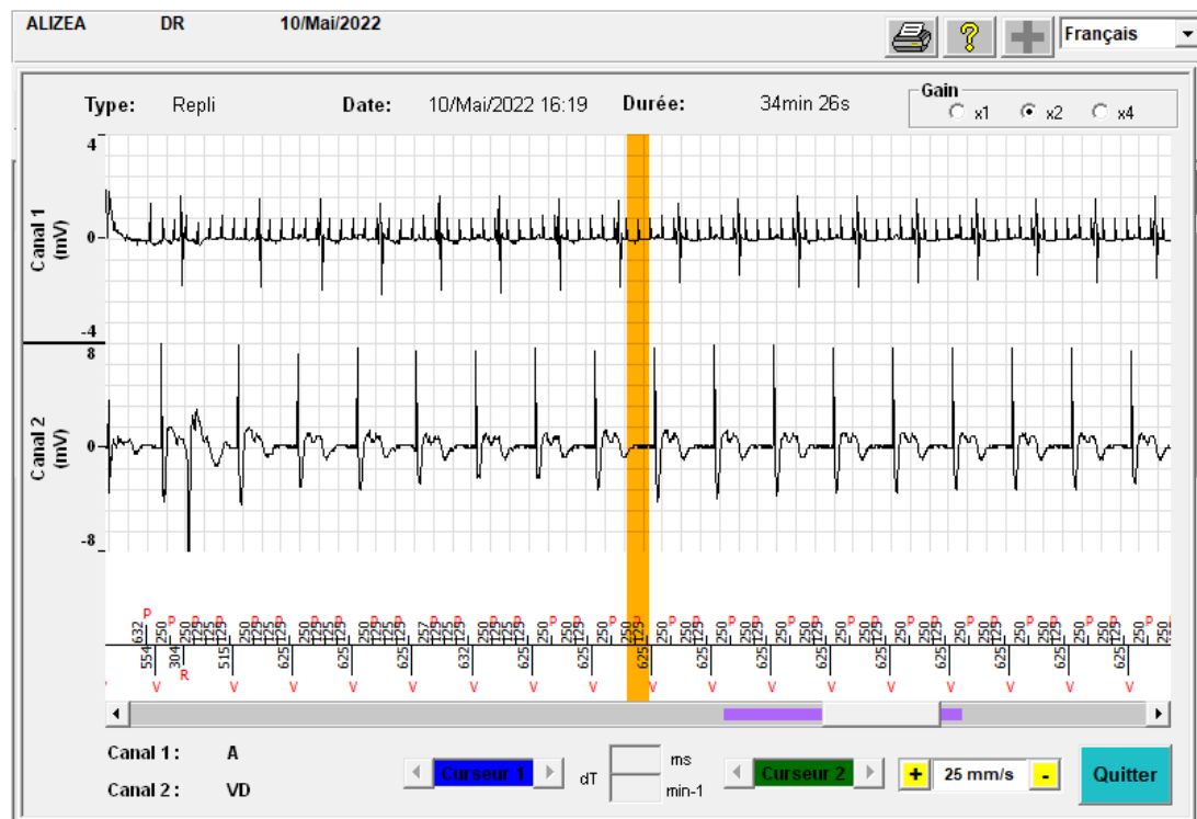
Figure 4: Illustration d'un épisode de "Repli" dû à une surdétection d'artefacts de la VM sur un stimulateur DR.
