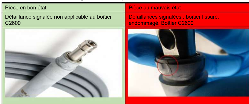
Figure 1 : Exemple de boîtier fissuré
