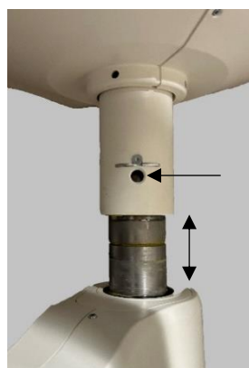
Figure 4 Installation incorrecte : la vis de fixation est manquante et/ou le bras est abaissé
