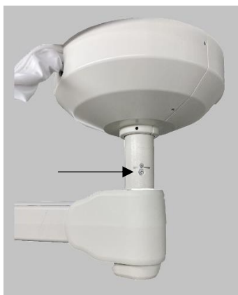
Figure 3 Installation correcte : la vis de fixation est présente et aucun dommage n'est visible
