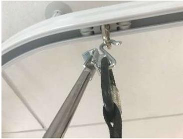
4. Faites glisser vers le bas le bras d'extension télescopique afin de désolidariser le crochet de l'aimant du bras télescopique.
