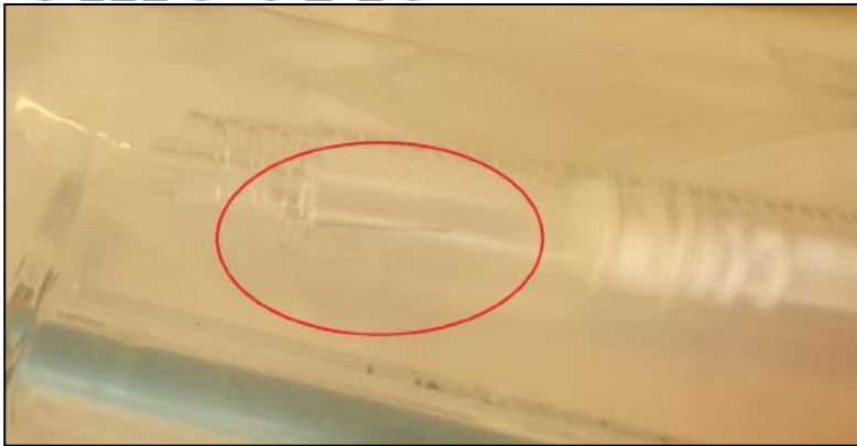
Picture 1: fissure sur le corps de la seringue
