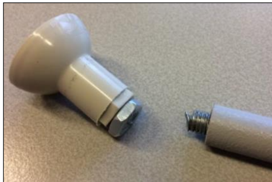
Boulon cassé Cela peut entraîner la chute du flexible de câble
