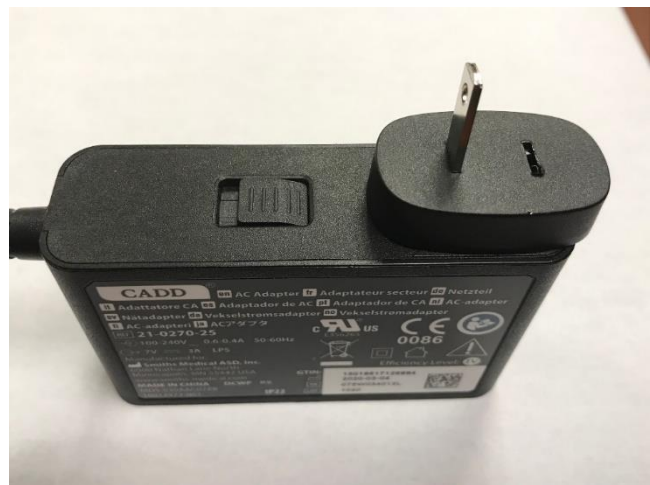
Figure 3: Adaptateur secteur présentant une broche manquante
