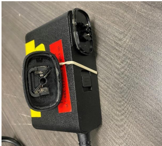
Figure 2: Fiche d'entrée endommagée
