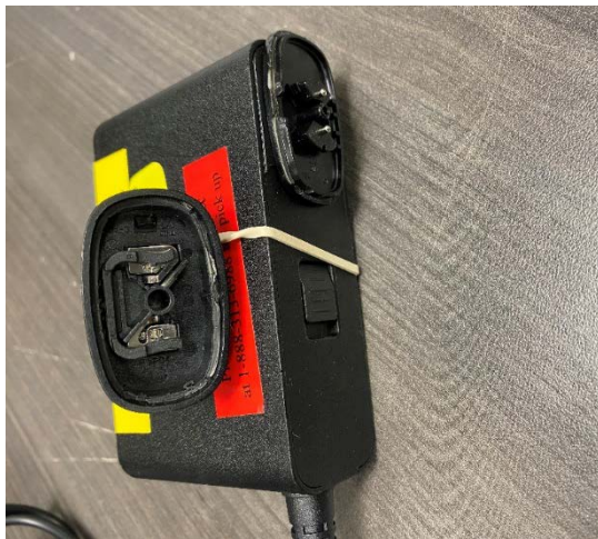
Figure 2: Fiche d'entrée endommagée
