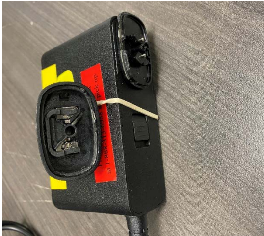
Figure 2: Fiche d'entrée endommagée
