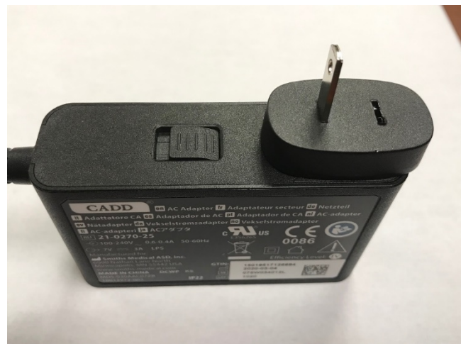
Figure 3: Adaptateur secteur présentant une broche manquante
