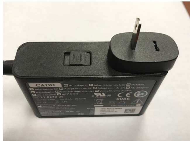
Figure 3: Adaptateur secteur présentant une broche manquante
