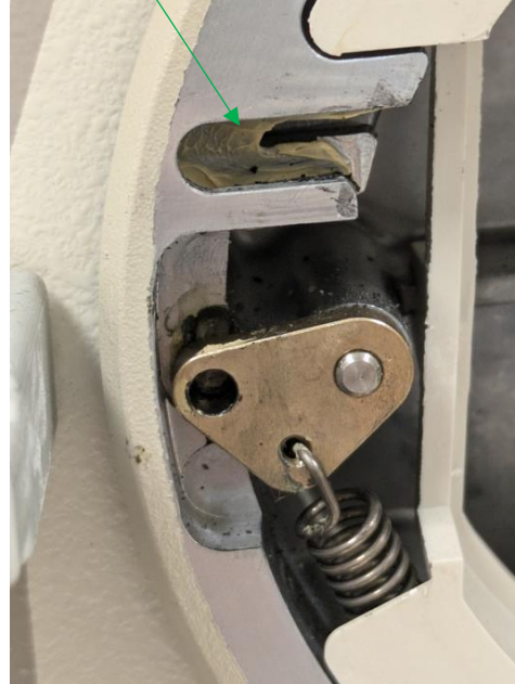
Figure 2: Lubrification acceptable dans le canal du rouleau en bronze
