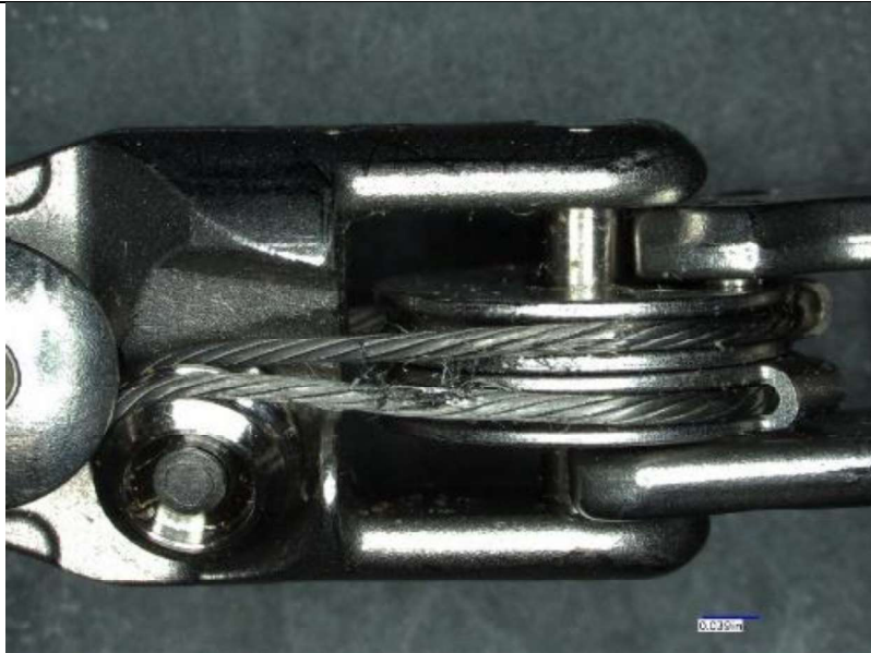
Figure D : Grossissement au facteur 20 d'un câble effiloché sur un instrument da Vinci Xi.
