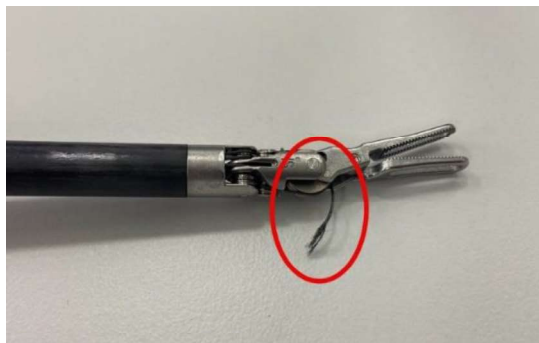
Figure H : Câble rompu
