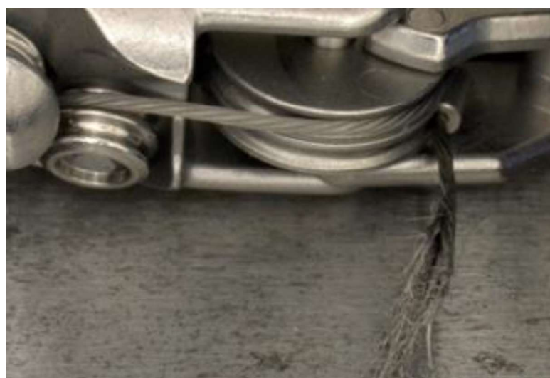
Figure C : Grossissement au facteur 20 d'un câble rompu sur un instrument da Vinci Xi .
