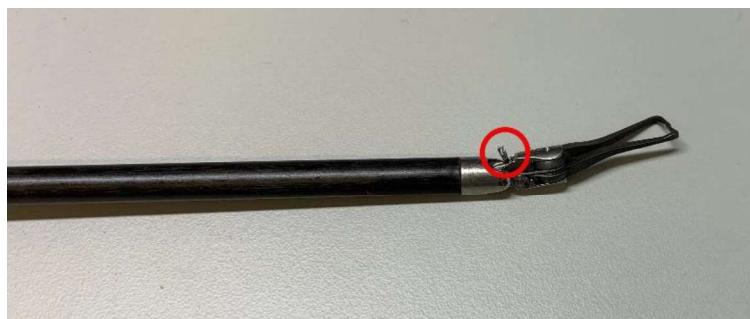
Figure F : Câble d'inclinaison rompu
