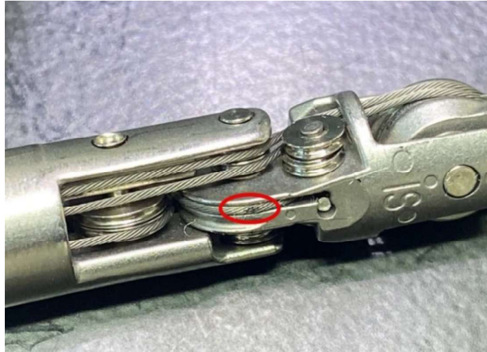
Figure G : Câble d'inclinaison effiloché
