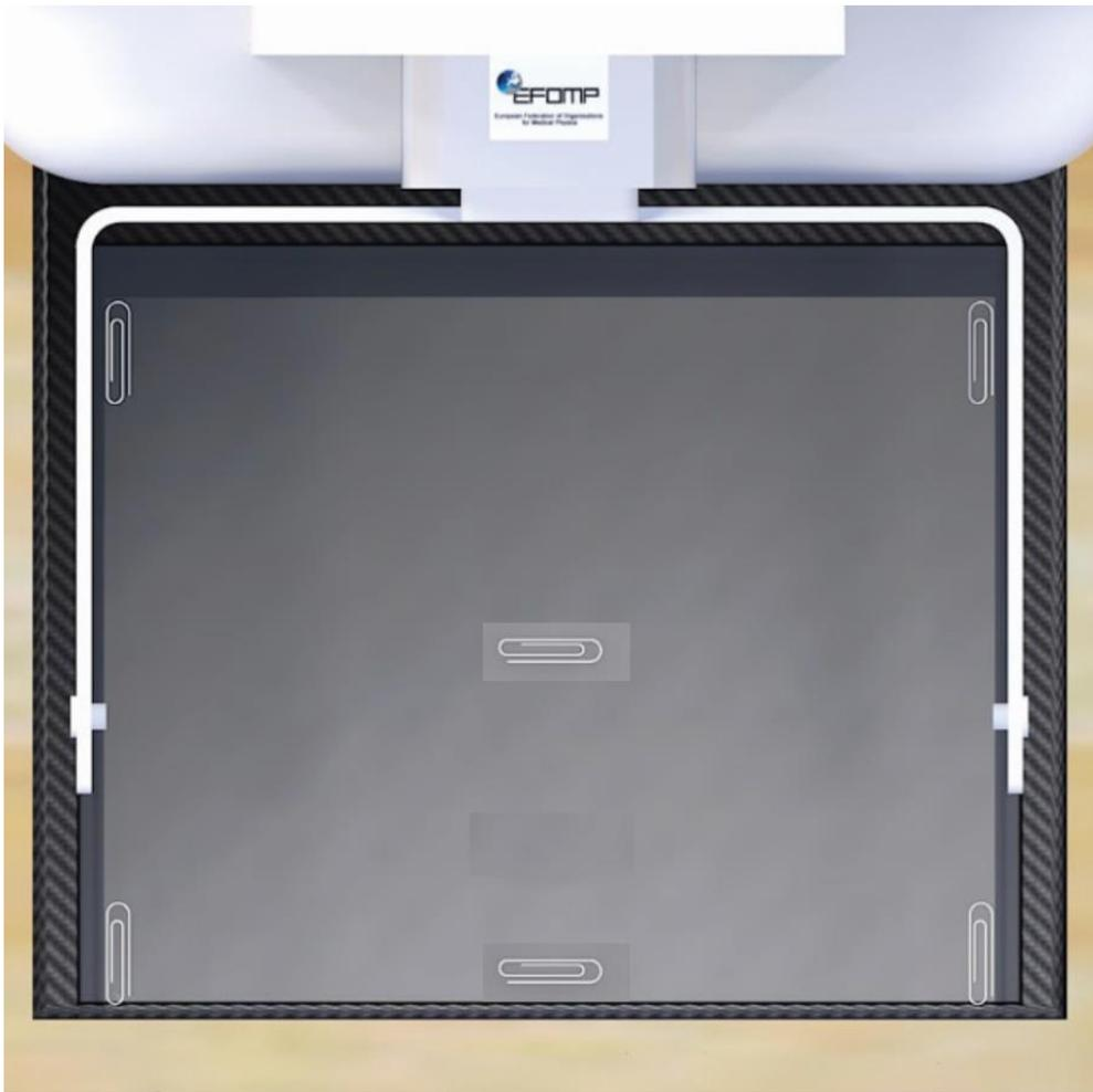
Figure 14 : Montage pour la réalisation du test de tissu manquant à la base et au sommet de l'image de tomosynthèse reconstruite
