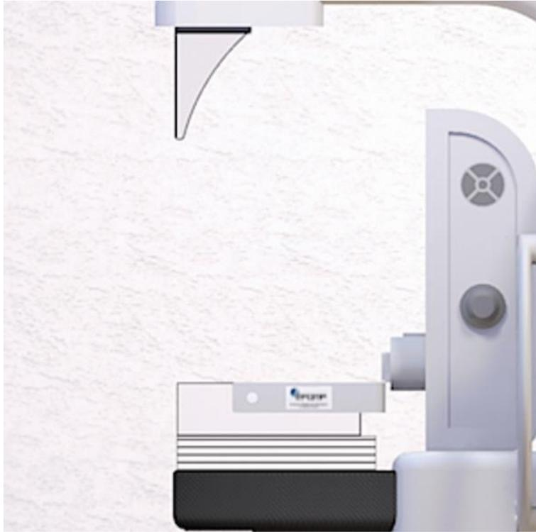
Figure 5 : Montage pour la réalisation du test d'homogénéité de l'image de tomosynthèse reconstruite et suivi du SNR
