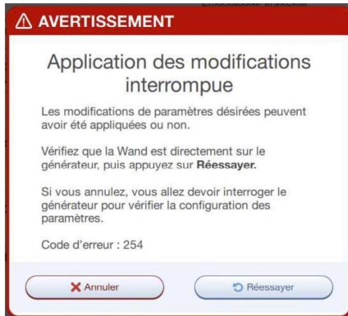
Figure 2 : message « Error Code 254 – Apply Changes Interrupted » (Code d'erreur 254 – Appliquer mod. interrompu) affiché pendant la programmation
